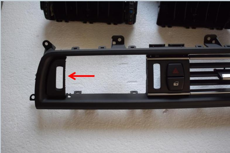
Entfernen sie die Gitter von dem Düsenteil Fahrerseite. Diese sind nur unten eingeklipst.
