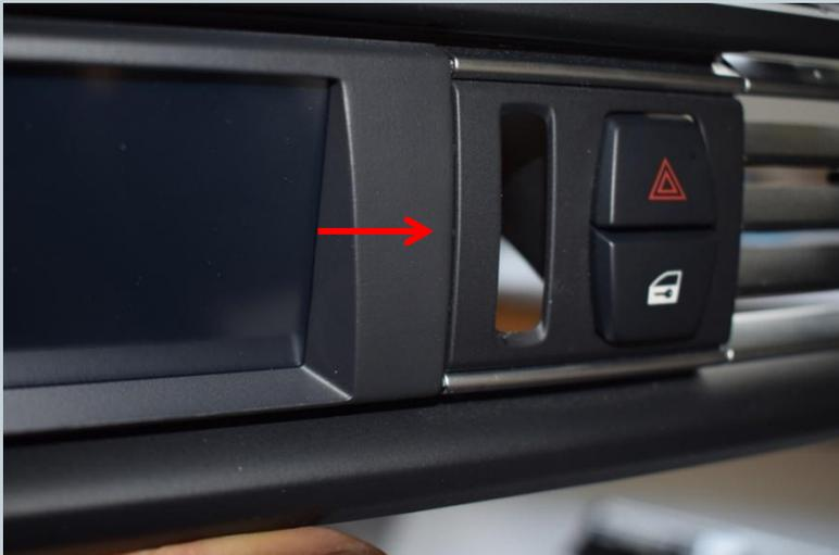
Jetzt kann die linke Seite vorsichtig eingerastet werden. Achten sie darauf, dass kein Dorn für die Befestigung abgebrochen wird und keine Spannung im Display Rahmen entsteht.
