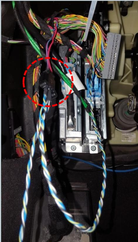
Die Stecker (rot markiert) zusammenstecken. Das Stecker Gehäuse kann wieder montiert werden und schließlich in das Steuergerät wieder eingesteckt werden.
