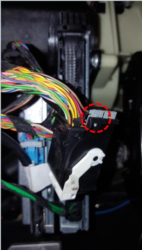
Den Schwarzen Stecker abstecken und aus dem Stecker Gehäuse raus ziehen. Das Gehäuse ist von beiden Seiten eingerastet (rot markiert).
