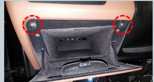
Beim Ablagefach 2 Schrauben lösen und das Fach rausziehen.
