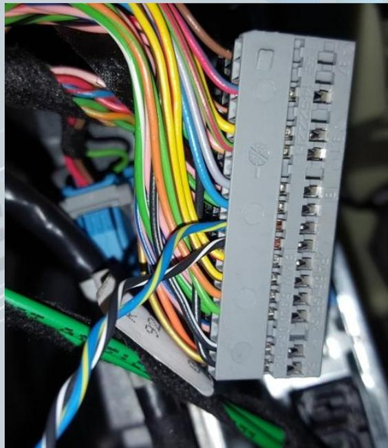
Die mit gelieferte CAN Leitung entsprechend wie im Bild einpinnen.
