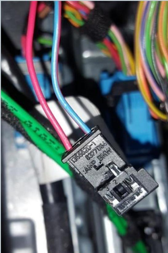
Die ausgepinnte CAN Leitung in den mit gelieferten Stecker einpinnen. Dabei „blau/rot“ auf **Pin\_1** und „rot“ auf **Pin\_3**. Die Nummerierung ist am Stecker gekennzeichnet.
