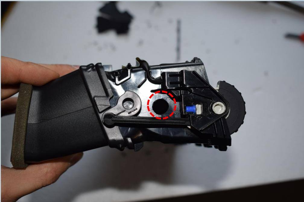
**TIPP:** Das Kabel von innen mittels Kabelbinder befestigen um eine Zugentlastung zu schaffen.
