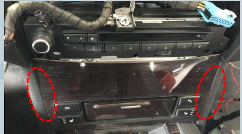
Die Verkleidung der Schaltzentrums in der Mittelkonsole muss außenrum ausgeklippt werden.
