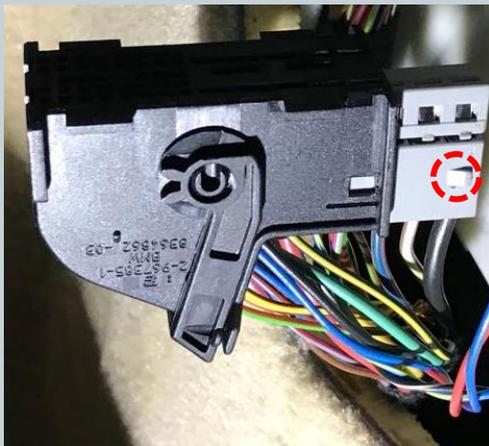
Dabei mit einem kleinen Schlitzschraubendreher seitlich auf die Pins drücken und ziehen. Zuerst auf die rot markierte Fläche Drücken und raus ziehen, danach auf die grüne Fläche. Diesen Vorgang für jede Ader einzeln durchführen.
