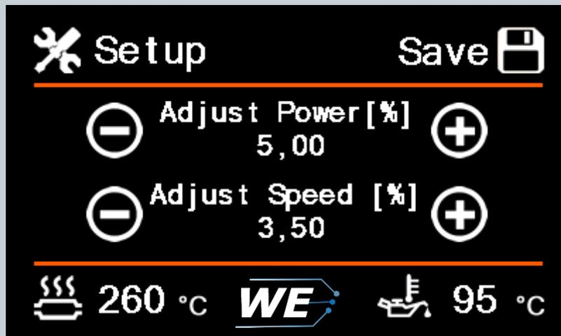
In diesem Setup Menü ist es möglich die angezeigte Leistung und Geschwindigkeit zu korrigieren.
