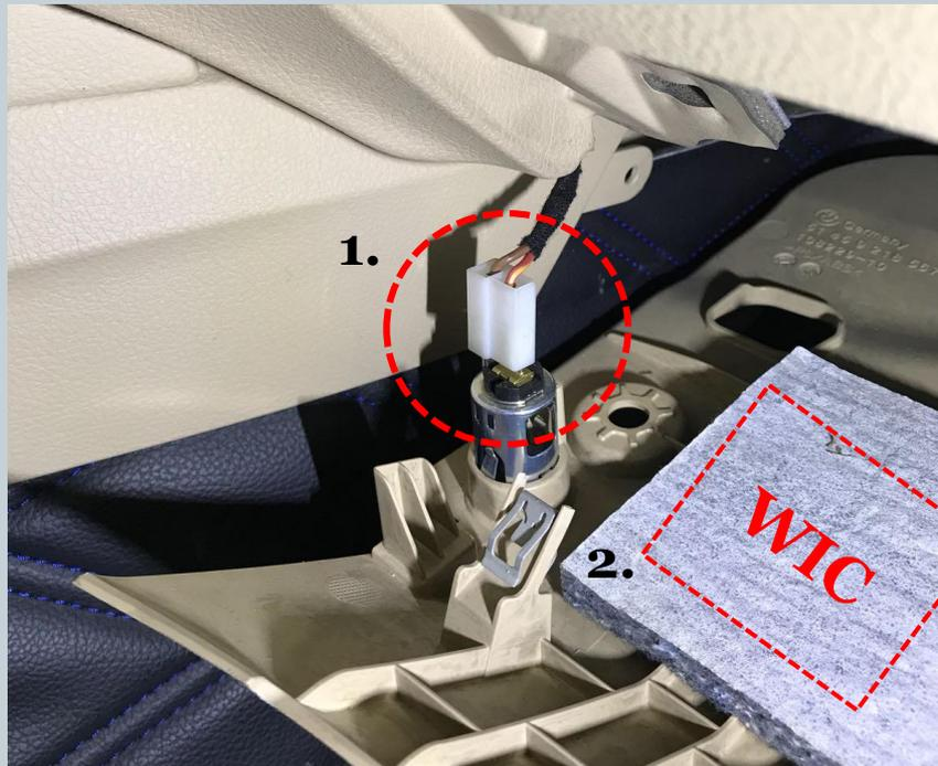
1. Die Versorgung für das WIC Steuergerät kann von der 12V Ladebuchse im Fußraum Beifahrerseite entnommen werden. Diese ist bereits ausreichend abgesichert.
