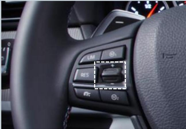
1. Mit Hilfe der Wippen am MFL kann zwischen den einzelnen Screens schnell umgeschaltet werden. Hierfür die Wippe leicht nach oben oder nach unten betätigen.
