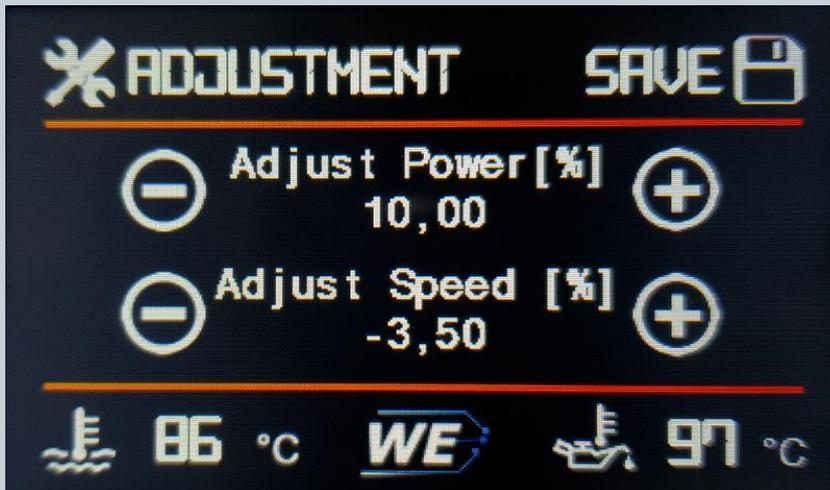
In diesem Setup Menü ist es möglich die angezeigte Leistung und Geschwindigkeit zu korrigieren.
