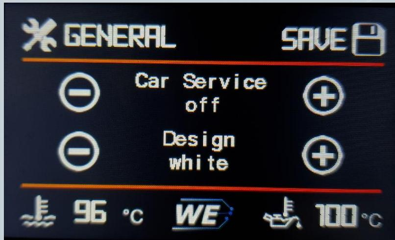
Sobald sie Car service auf On setzen, werden sie gefragt ob sie zusätzlich das Display ausschalten möchten. Wir empfehlen auf YES zu drücken. Damit sind sie sicher dass das Display inaktiv ist.
