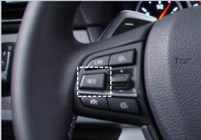
Wenn eine Abgasklappe werkseitig verbaut wurde kann diese per „Res“ Taste angesteuert werden. Es gibt 3 Modi (Auto, On und Off).
