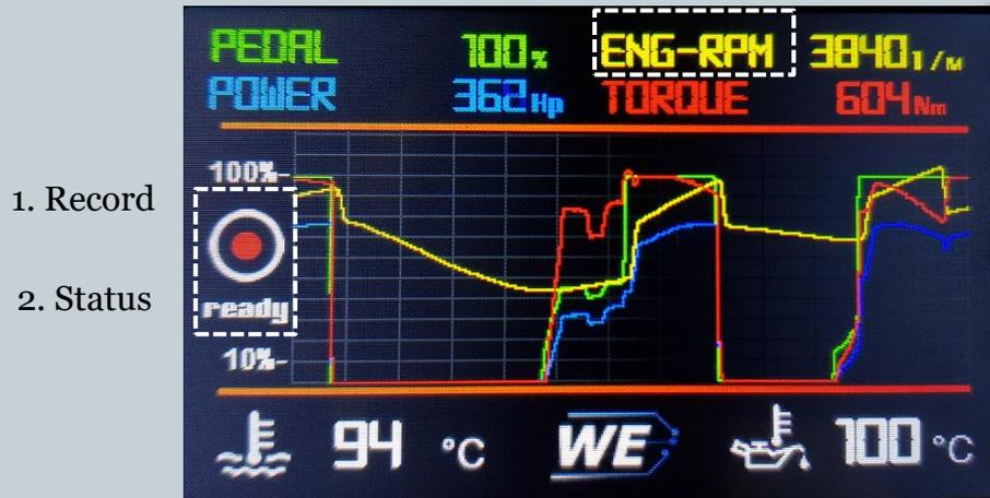
Im Graph können 4 Werte beliebig konfiguriert werden. Hierzu auf den Namen des Signals drücken. Im weiteren Menü können sie das Signal und die Skalierung einstellen.
