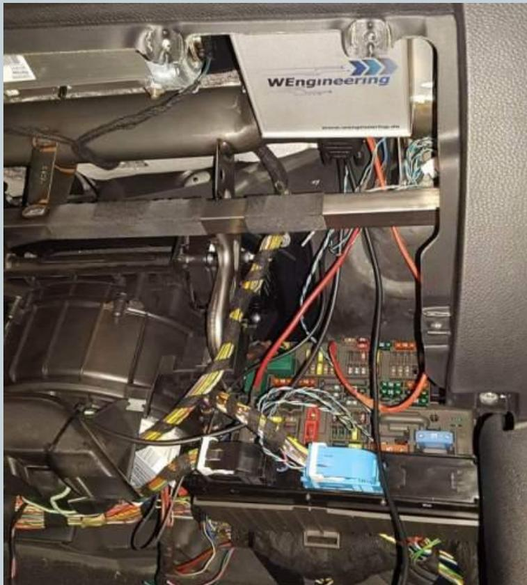
Das Steuergerät wird im Fußraum Beifahrerseite platziert. Die Einbauposition ist nach Platzverfügbarkeit zu wählen. Gegebenenfalls muss das Handschuhfach ausgebaut werden. Schließen sie die beiden Stecker am Steuergerät an.
