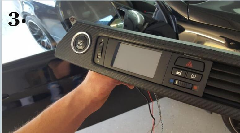
1. Langloch für die Kabel bohren. Nach der Montage des Displays die Kabel mit einem Kabelbinder fixieren.
