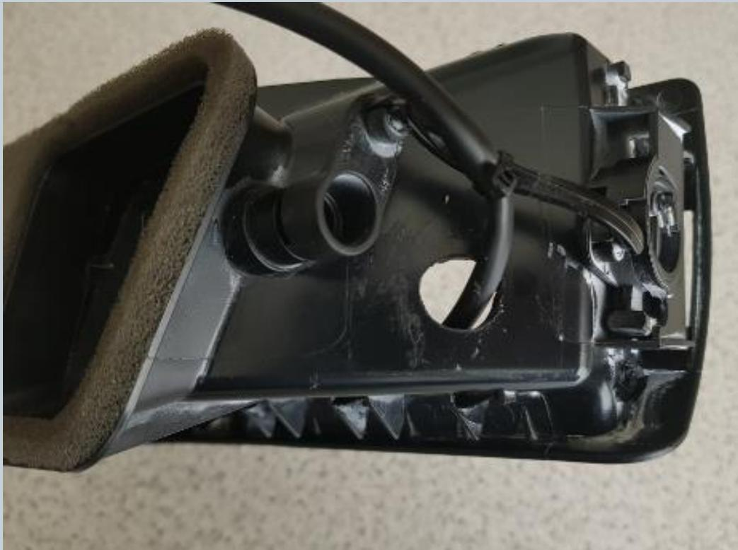
1. Langloch für die Kabel bohren. Kabel durchführen und mit einem Kabelbinder siehe Bild fixieren.
