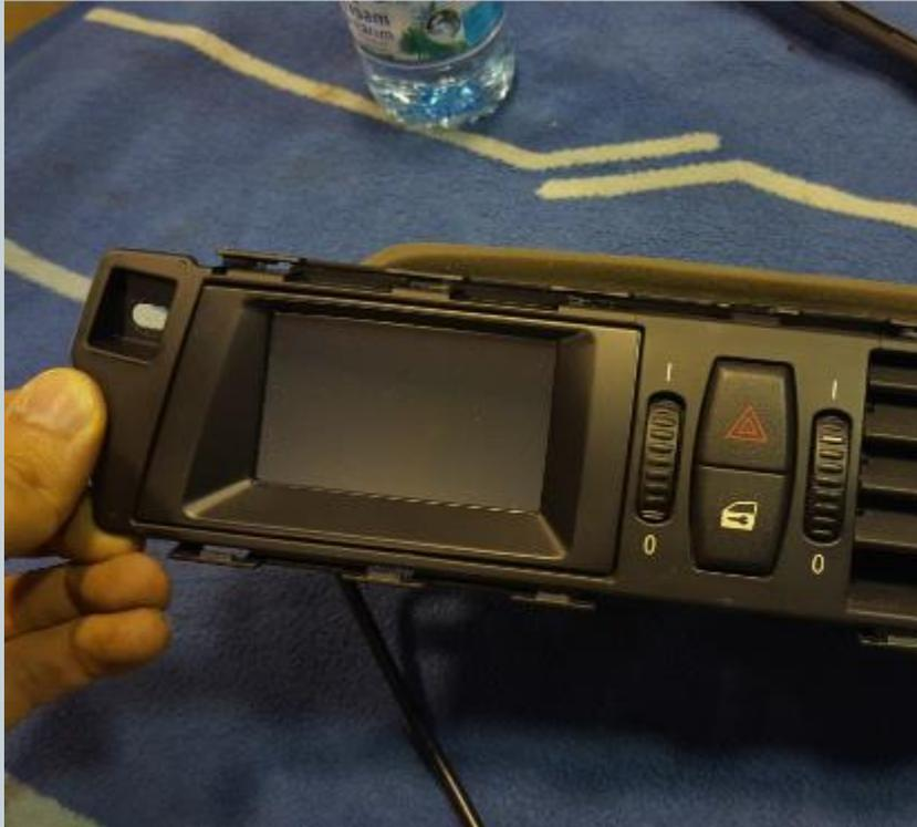
Den Vorderteil der Lüftung wieder einsetzen. **Die untere Seite zuerst.** Jetzt kann die Lüftungseinheit wieder mit der Interieurleiste verschraubt werden.
