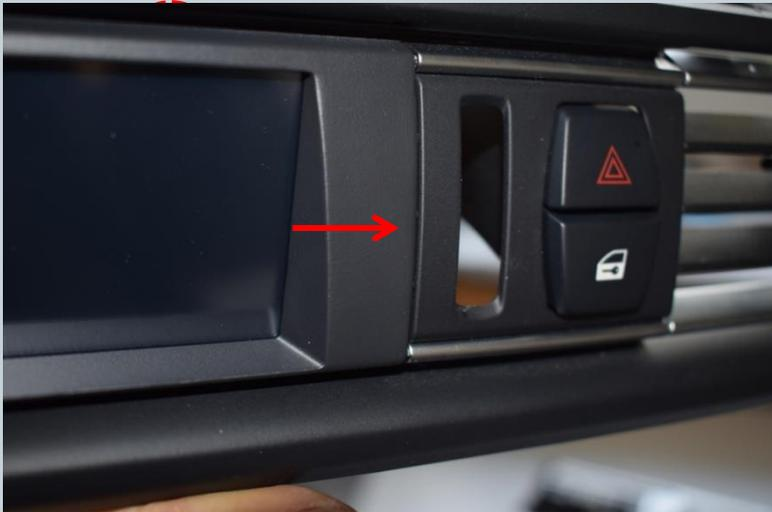
Jetzt kann die linke Seite vorsichtig eingerastet werden. Achten sie darauf, dass kein Dorn für die Befestigung abgebrochen wird
