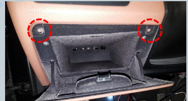
Beim Ablagefach 2 Schrauben lösen und das Fach rausziehen. In diesem Bereich findet das WMI Steuergerät Platz.
