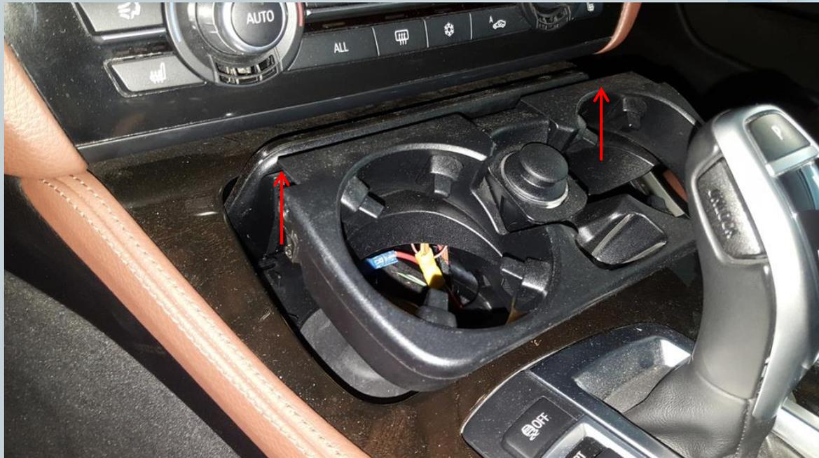
Beim vor LCI Modell kann der Becherhalter durch ein einfaches Ziehen nach oben ausgebaut werden. Beim LCI muss die Mittelkonsole ausgebaut werden um an den Zigarettenanzünder zu kommen. Die Mittelkonsole ist mit einer Schraube befestigt.
