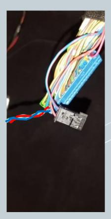
Die ausgepinnte CAN Leitung in den mit gelieferten Stecker einpinnen. Dabei "blau/rot" auf **Pin\_1** und "rot" auf **Pin\_3**. Die Nummerierung ist am Stecker gekennzeichnet.
